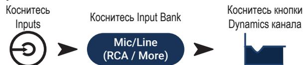
1. Кнопка **Dynamics** (динамическая обработка): выбирает экран Compressor / AGC (компрессор/APU).
